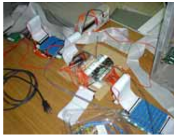
(c) 裝上電控制線路後可由電腦直接控制光通道的add and drop
